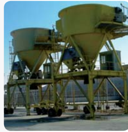
2 Trémies autonomes, dépoussiérées et tractées sur châssis. Manche télescopique de chargement camion. Débit : 350 t/h Produit : Coke et charbon 2 self sufficient, dedusting and towed hoppers. Telescopic chute for truck loading. Output : 350 tph - Product : coke and coal
