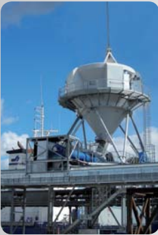
Trémie dépoussiérée et mobile sur rail. Reprise par vis et alimentation d'un transporteur de quai étanche. Débit : 600 t/h - Produit : ciment Dedusted and rail mounted hopper. Reclaiming by screw and feeding dust sealed wharf conveyor. Output : 600 tph - product : cement
