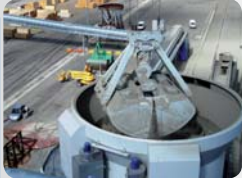
Trémie dépoussiérée et mobile sur rail. Reprise par vis et alimentation d'un transporteur de quai étanche. Débit : 600 t/h - Produit : ciment Dedusted and rail mounted hopper. Reclaiming by screw and feeding dust sealed wharf conveyor. Output : 600 tph - product : cement
