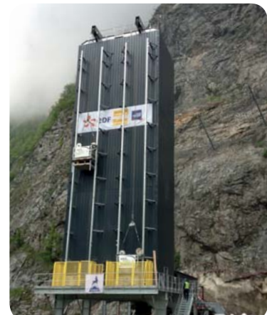
Tension par treuil et contre poids. Conception sur mesure. Réserve de 250 m à 500 m. Possibilité de bardage et couverture. Tension by winch and counterweight. Bispote design. from 250 m to 500 m belt bank. Cover and cladding able.
