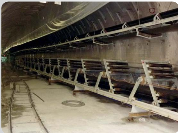
Tension par treuil et contre poids. Conception sur mesure. Réserve de 250 m à 600 m. Équipé de chariot mobile sur rail. Possibilité de bardage et couverture. Tension by winch and counterweight. Bispote design. From 250 m to 600 m belt bank. Fitted with mobile trolley on rail. Cover and cladding able.
