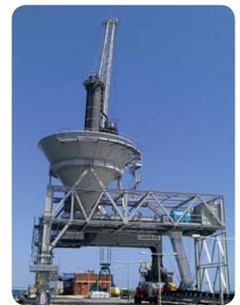
2 trémies de quai Produit : Charbon Débit : 4000 t/h 2 wharf hoppers Product : coal Output : 4 000 tph
