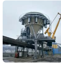
Trémie de quai Motorisée sur rails Débit : 1000 t/h Produit : multi-vracs Wharf hopper Motorized on rails Output : 1000 tph Product : multi-bulk
