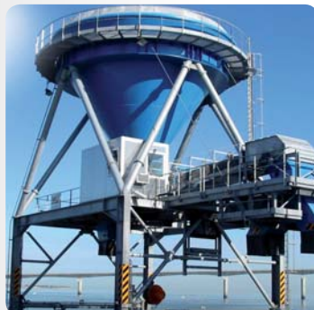
Trémie de quai de capacité 200 T mobile sur rail. Reprise par bande et chargement de camion en direct avec calibrage d'un poids prédéfini. Débit : 600 t/h - Produit : multi-vrac One wharf hopper mobile on rails. Reclaiming by conveyor belt with scale for trucks loading. Output capacity : 600 tph - product : multi-bulk Useful capacity : 200 T
