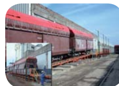
TERMINAL CLINKER automatique : « déchargement wagons, mise en stock, Reprise et chargement bateaux » Débit : 800 t/h.
