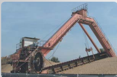
Reprise par grappeur portique à 800 m 3 /h de copeaux de bois. Longueur de flèche : 22 m - Hauteur de tas : 11,5 m Angle de travail : 0 à 45° Reclaiming of woodchips by portal scraper at 800 m 3 /h. Boom length : 22 m - Stockpile height : 11,5 m Slope angle : 0 to 45°
