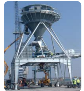
Trémie dépoussiérée sur pneus Produit : clinker, laitier et ciment Débit : 600 t/h Dedusted hopper on tires Product : clinker, slag and cement Output : 600 tph
